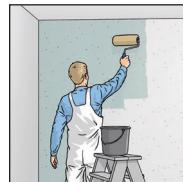
2b. Pose par la technique d'encollage du mur sans détrempe.
